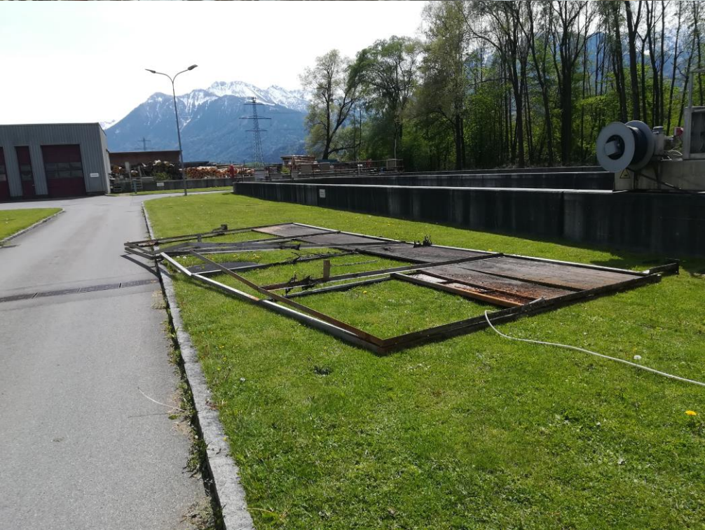
Die Belüftungsverrohrung wurde beschädigt und musste erneuert werden.
