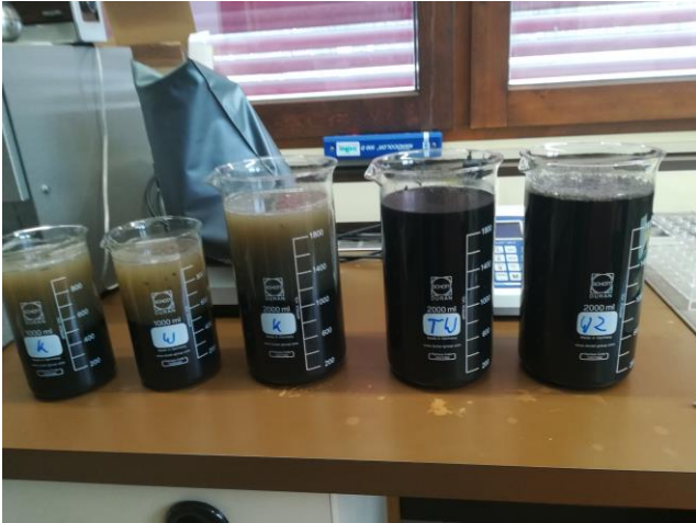
Schlammabsetz – Tests im Labor
